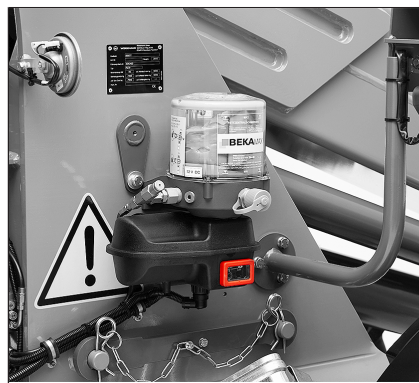
Obr. 220: Poloha centrálního mazacího zařízení na vozidle
