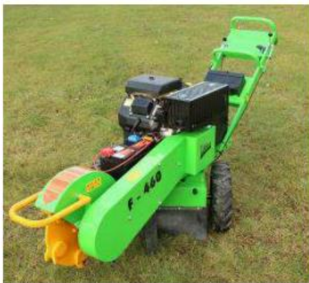
Kývání otočí z jedné strany na druhou při odjištěné aretaci otoče
