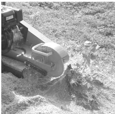
Postupné odfrézování z jednotlivých stran
