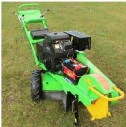
Kývání otočí z jedné strany na druhou při odjištěné aretaci otoče
