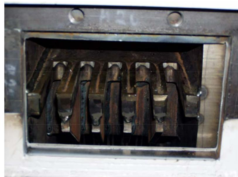
připevnění protikomory na rám konstrukce
