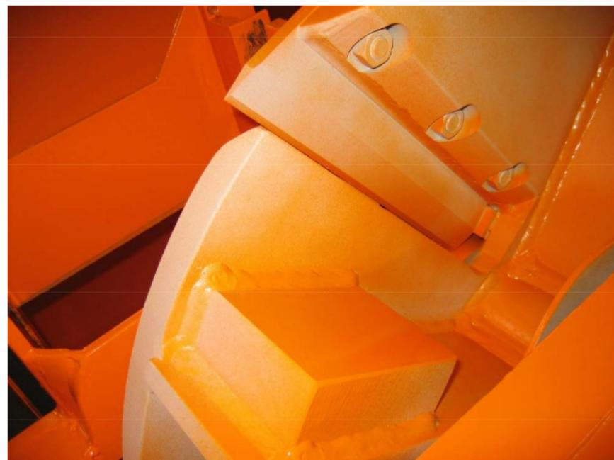
Hmotnost navíc a 4 velké lopatky ventilátoru, které jsou pevně spojeny s kotoučem až ke středové hřídeli.
